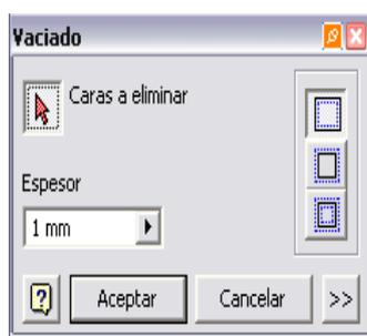
Figura 33. Ventana para vaciado.
